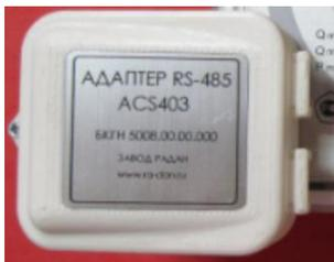
Адаптер RS-485 ACS403 позволяет удаленно снимать показания с приборов учета газа, образуя единую проводную сеть. При построении системы каждому счетчику присваивается номер, что позволяет отправлять запрос с компьютера на получение информации с конкретного счетчика.
